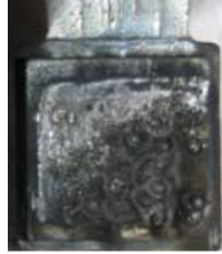
接点が摩耗している状態
